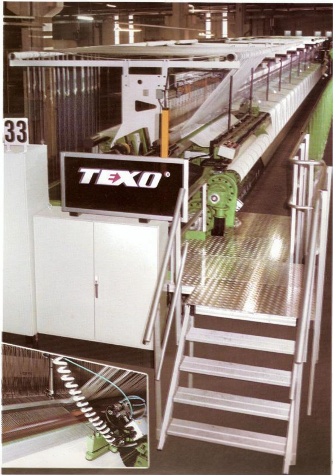
Telaio da mt. 26,00 per tessuti di base per feltri umidi Shuttle loom mts. 26,00 for base weaves of wet felts Webstuhl, 26,00 m. für flize-untergewebe
