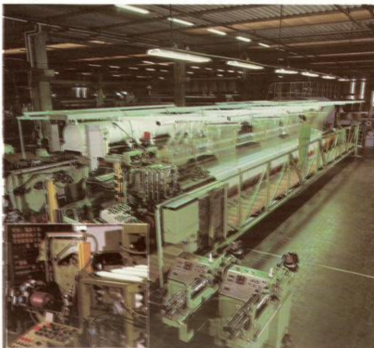
Telaio automatico da mt. 14,00 per tessuti di base per feltri umidi Automatic shuttle loom mts. 14,00 for base weaves of wet felts Automatischer Webstuhl, 14,00 m. für filz-untergewebe
